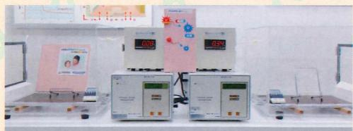
ショールームに置かれている実験装置。ホルムアルデヒド濃度が0.34ppmである容器の中に『タイガーハイカーリンボード』を入れると、吸収分解機能により、2時間程度で厚生労働省の室内濃度指針値(0.08ppm)を下回る0.07ppmとなりました。
